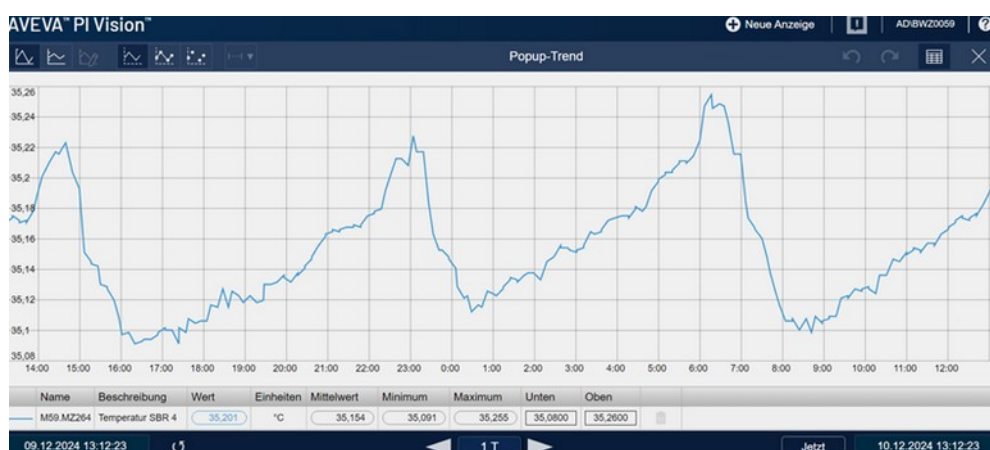
Abbildung 4: Darstellung Temperaturanstieg pro Zyklus in der Anammox-Stufe
