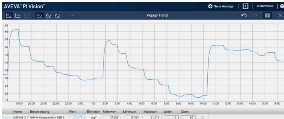
Abbildung 3: Darstellung Verlauf Konzentration Ammoniumstickstoff (drei SBR Zyklen von je 8h)
