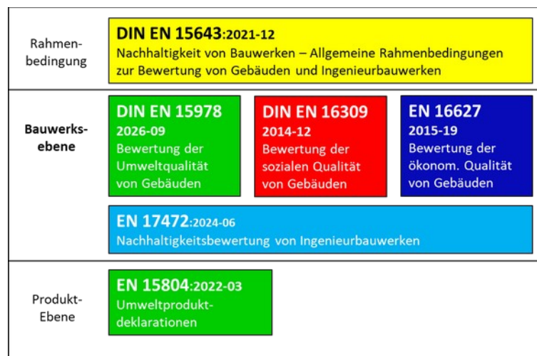
Bild 1: Modularer Aufbau der Normstruktur „Nachhaltigkeit von Bauwerken“
